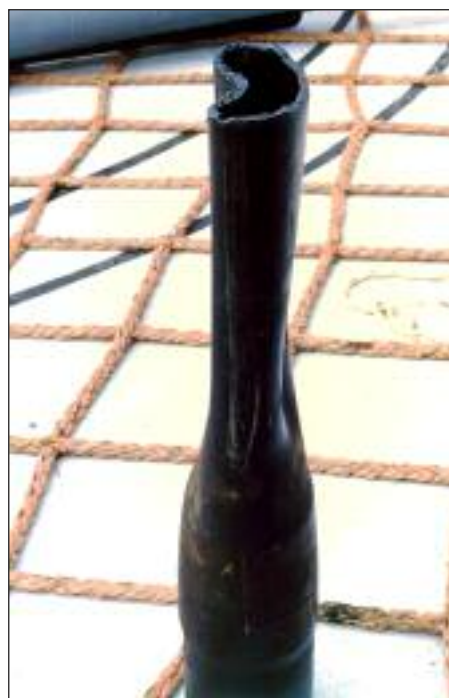
Figura 3. Tubería de 7" de diámetro fabricada con acero P-110, 26 Lb/pie, colapsada.
