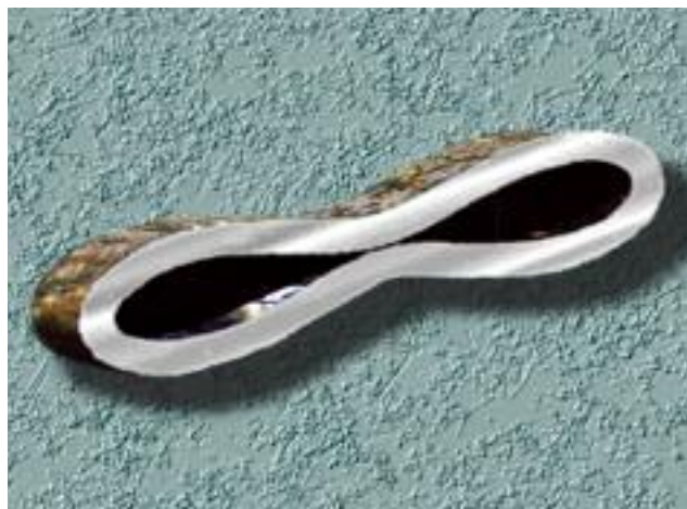
Figura 2. Tubería de 7" de diámetro, colapsada
