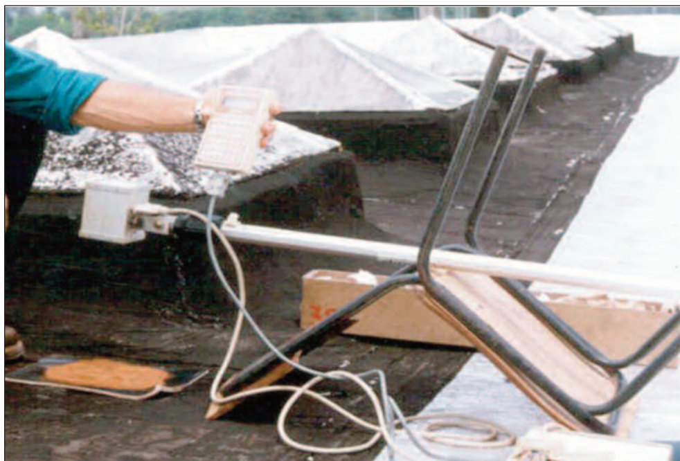
Figura I.13. La medición de la Reflectancia Espectral a la muestra de suelo se realiza con el Radiómetro Multiespectral CROPSCAN Modelo MSR5.
