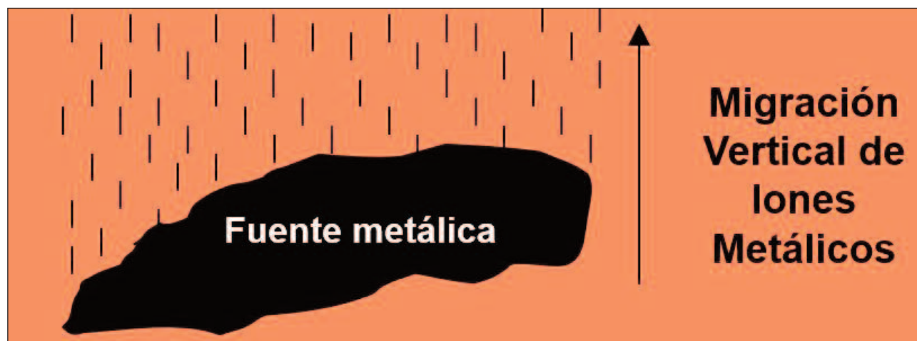
Figura I.2. Esquema que representa el Principio de la Migración Vertical de Iones Metálicos desde una fuente metálica hacia la superficie.
