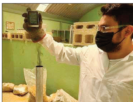
Figura 26. Medición de la concentración de \text{CO}_2 , previo al filtro
